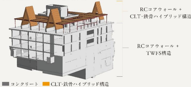
CLT・鉄骨ハイブリッド構造概念図
